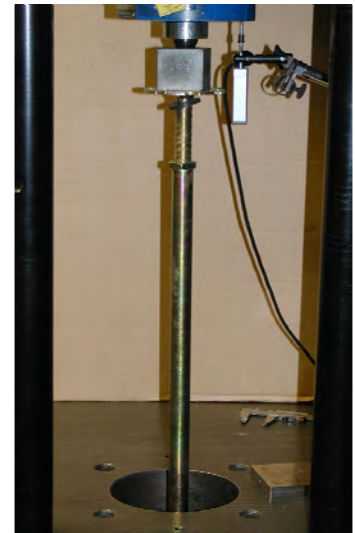
Bild 4: Prüfanordnung bei vertikal zentrischer Stützenbelastung
