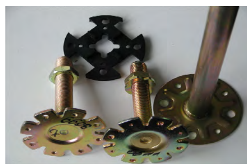
Bild 1: Einzelteile der geprüften Unterkonstruktion, Stützenfuß (Variante 1), Stützenkopf (zwei Ausführungen) und Auflageelement
