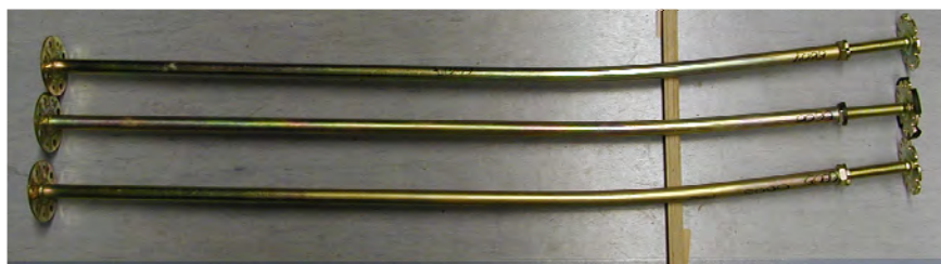
Bild 3: Prüfmuster #6605 bis #6607, Verhalten der Stützen nach dem Erreichen der Versagenslast, Ausknicken des Stützenrohres
